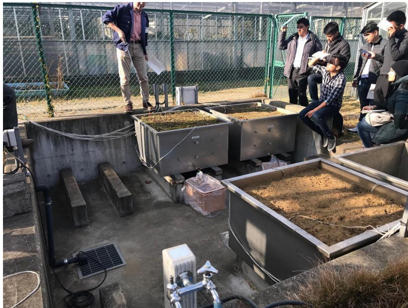
Figura 49. Lisímetros con balanzas y drenaje.
