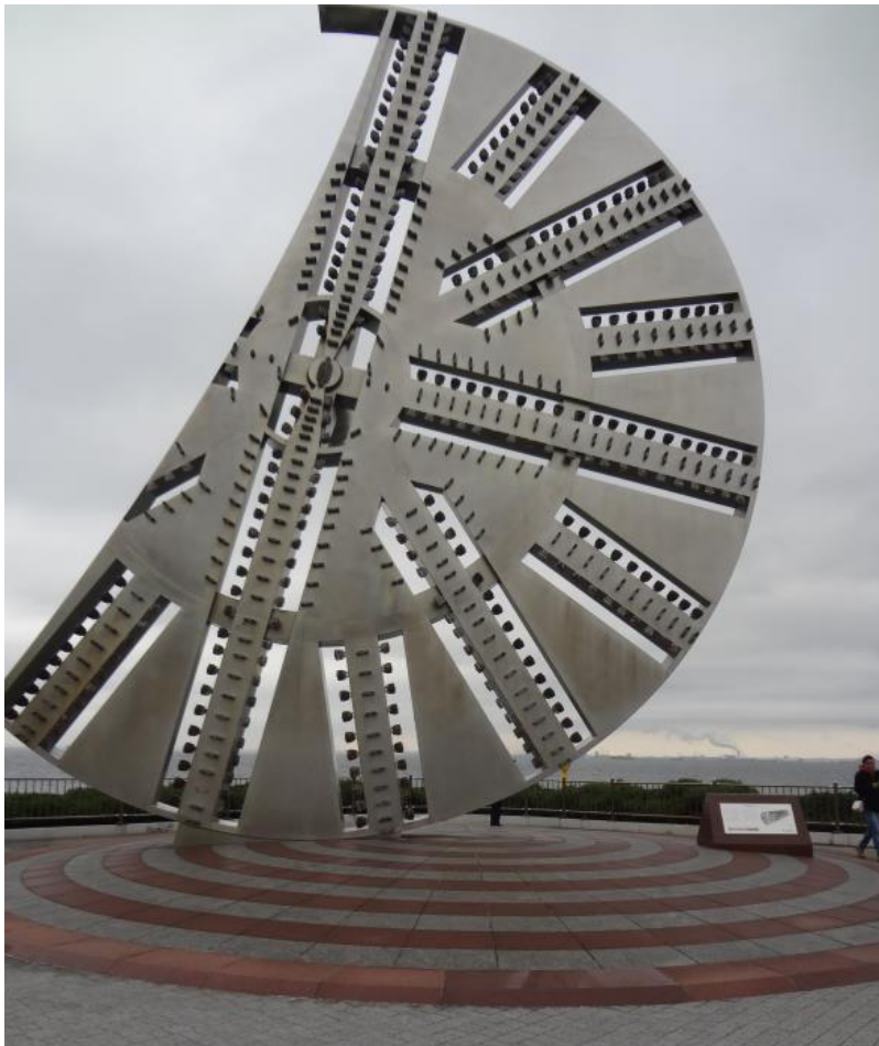
Ilustración 32 Cara del cortador de una de las máquinas de protección de lodo utilizado para perforar el túnel submarino para el Tokyo-Wan Aqua-Line Highway
