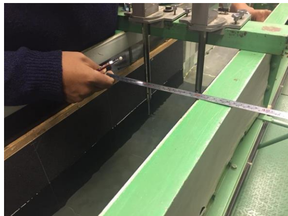
Ilustración 69. Mediciones geométricas del canal
